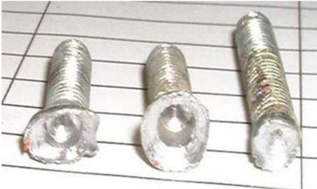
شکل ۱. لهیدگی در گل پیچ ستاره ای و آلنی
