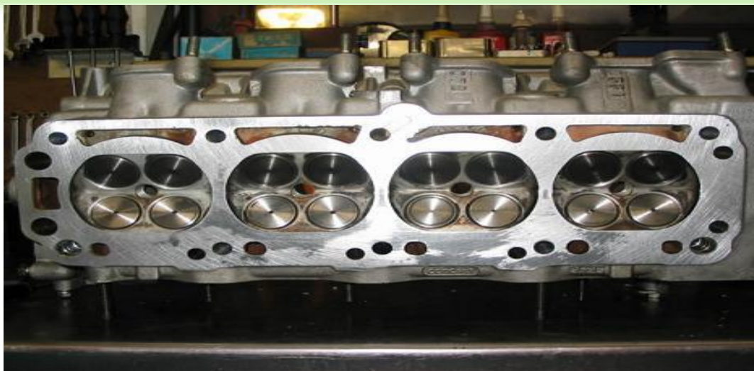
شکل ۲: نمایی از عیوب به وجود آمده در سرسیلندر
