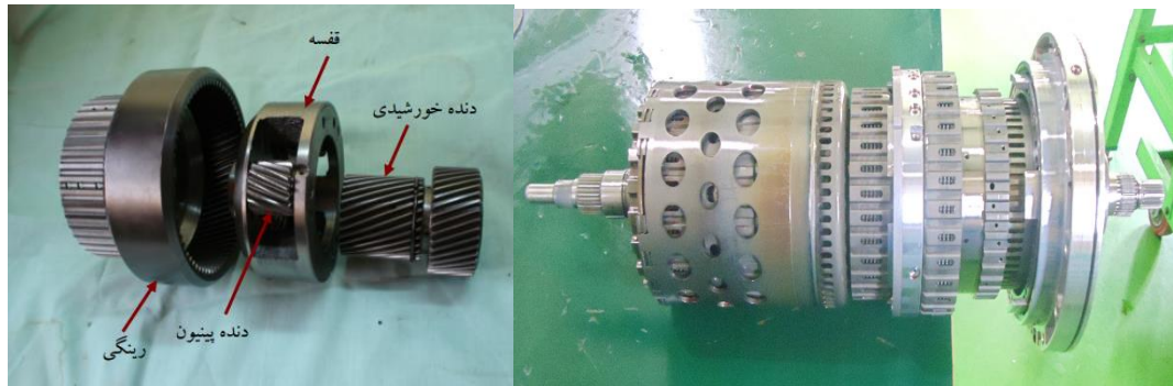
شکل ۵: مجموعه دنده سیاره ای و نمای داخلی گیربکس اتوماتیک جنسیس
